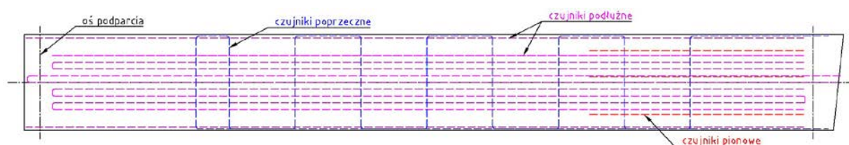
Rys. 4. Układ czujników światłowodowych: a) w przekroju poprzecznym; b) w widoku z góry na laminat okładzinowy górny
